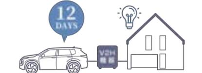
V2H機器と接続し、PHEVの電力を建物全体に供給。アウトランダーPHEVなら、満充電、ガソリン満タンで最大約12日分※2の電力を確保することができます。(エクリプス クロスPHEVは約10日分)
