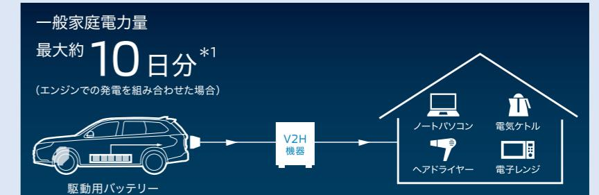
\*1:供給可能電力量は当社試算による(一般家庭での一日当たりの使用電力量を約10kWh/日として算出、V2H機器等の変換効率は含みません)。住宅との接続にはV2H機器が必要です。V2H機器に接続している場合、エンジン始動による発電はできません。エンジンでの発電を行う場合は、V2H機器との接続を終了してください。V2H機器については、営業スタッフまたは各V2H機器取扱メーカーにおたずねください。
